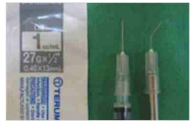
使用1c.c.空針針頭，套在三合一噴頭上，可以作為替代方式
