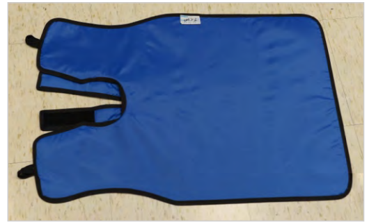
圖一、鉛衣放置平坦的表面上檢查
