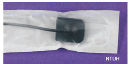
▲ (圖五) 塑膠保護套包覆Sensor及訊號線
